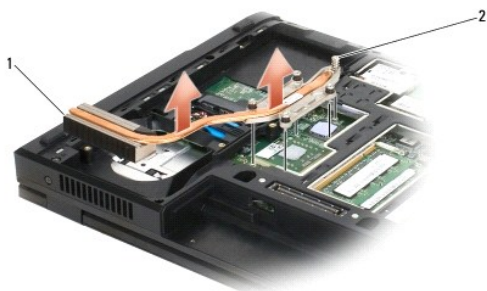
1 sklop hladila procesora E5500 2 pričvrсни vijci (5)
