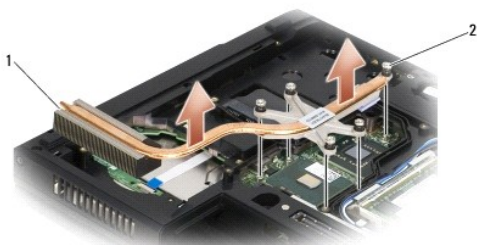
1 sklop hladila procesora E5400 2 pričvrсни vijci (5)
